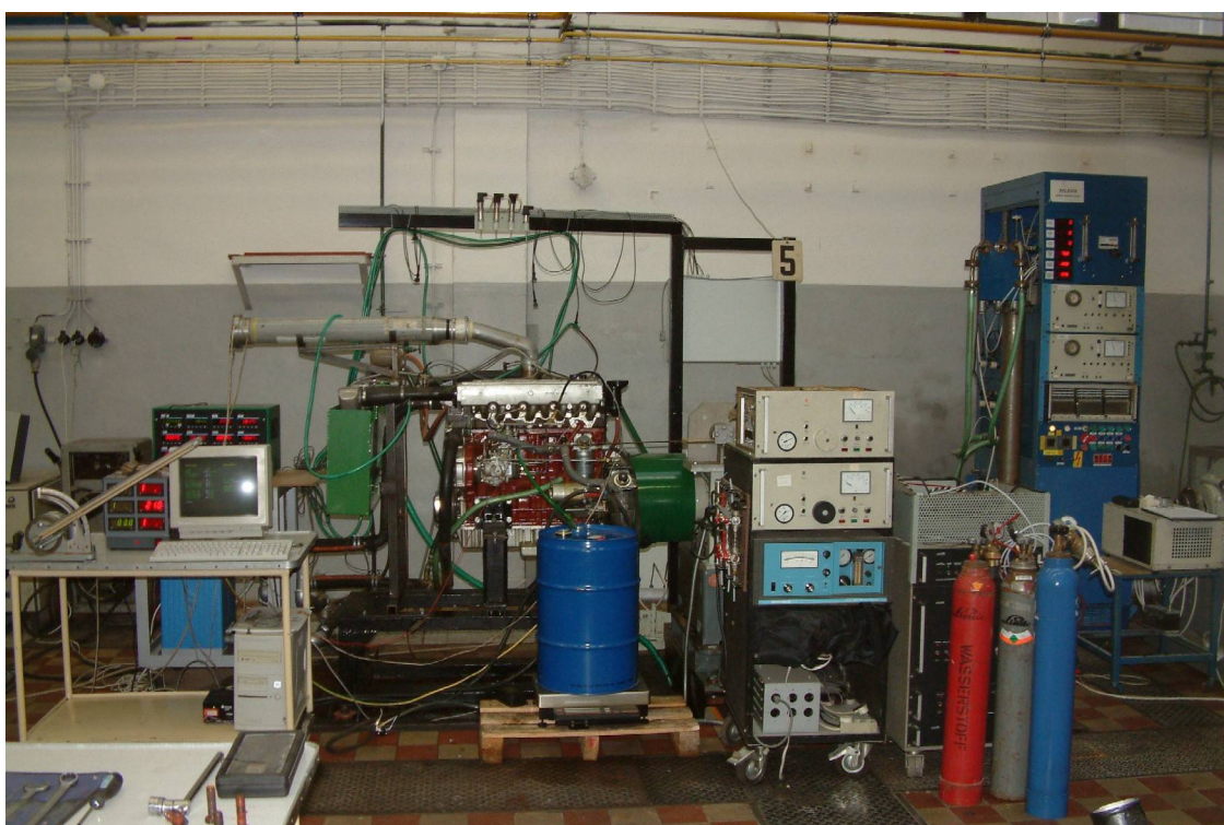
Obr. 5.1 Pohled na zkušební stanoviště - motor s dynamometrem a analyzátory výfukových plynů
